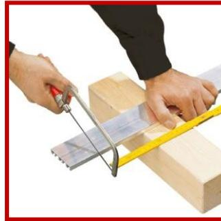
Ermitteln Sie die genaue Endlänge der Profile. Falls erforderlich mit einer Metallsäge kürzen.
