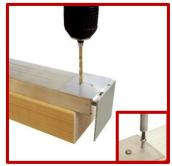
Legen Sie den Abschluss- und Haltewinkel an der Unterseite des Unterprofils so an der Kante an, dass der Wasserablauf frei bleibt (siehe Bild). Bohren Sie nun das Unterprofil 2 mal (Ø 3,5 mm) vor. Befestigen Sie anschließend den Winkel mit 2 Edelstahlschrauben (4,2 x 16mm) am Unterprofil.
