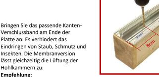
Profilunterteile im Abstand von 35 cm links und rechts vom Mittelsteg im Wechsel vorbohren (Ø 5 mm). Der Abstand der ersten Bohrung zur vorderen Kante beträgt 8 cm.
